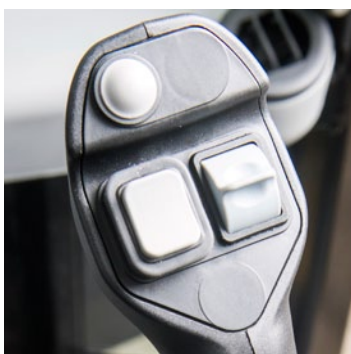
Circuit hydraulique auxiliaire à haut débit
